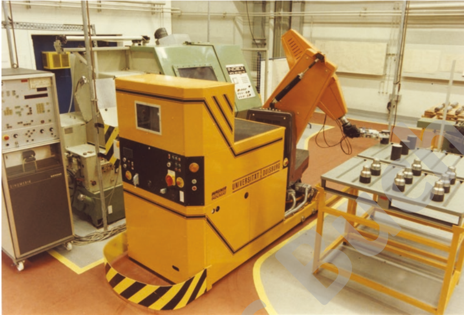
Abb. 1.9 Der weltweit erste mobile Industrieroboter MOBIROB. (Quelle: Universität Duisburg, Fachgebiet Fertigungstechnik, Prof. Dr.-Ing. D. Elbracht, 1985)
