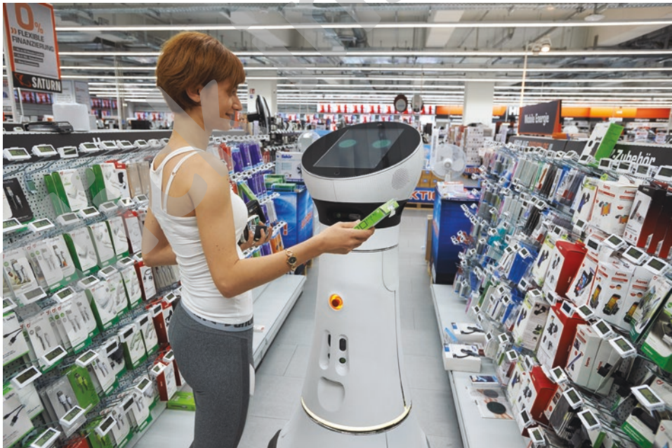
Abb. 1.11 Aktuelle Version des Care-O-bot, Anwendung: Kunden in einem Elektronik-Fachmarkt mit Produktinformationen versorgen/zum gesuchten Produkt führen. (Quelle: mojin robotics)
