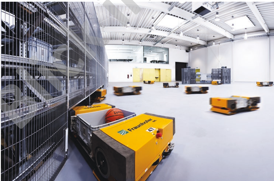
Abb. 1.10 Zellulare Fördertechnik/„FTS-Schwarm“ in der Versuchshalle des Fraunhofer IML in Dortmund (2011)
